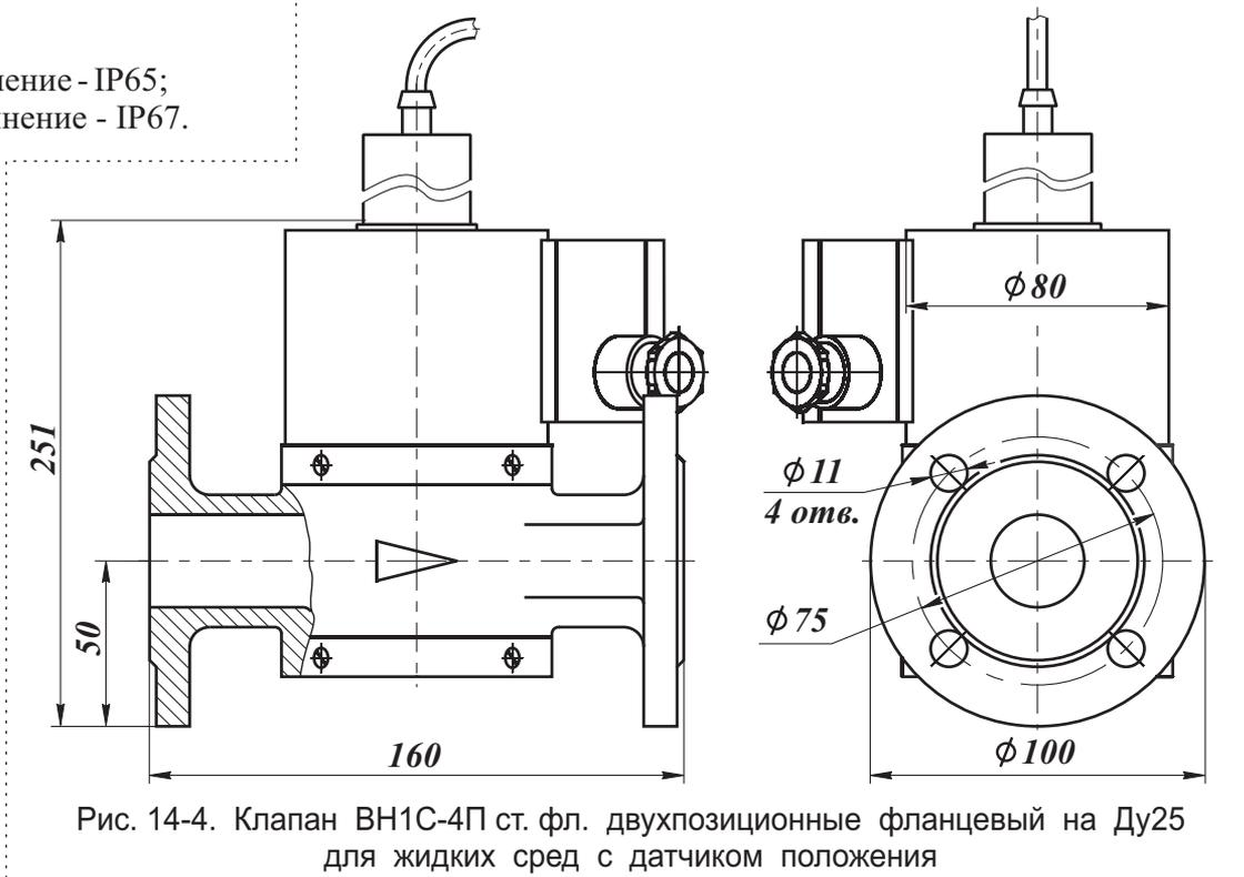
Рис. 14-4. Клапан ВН1С-4П ст. фл. двухпозиционные фланцевый на Ду25 для жидких сред с датчиком положения
