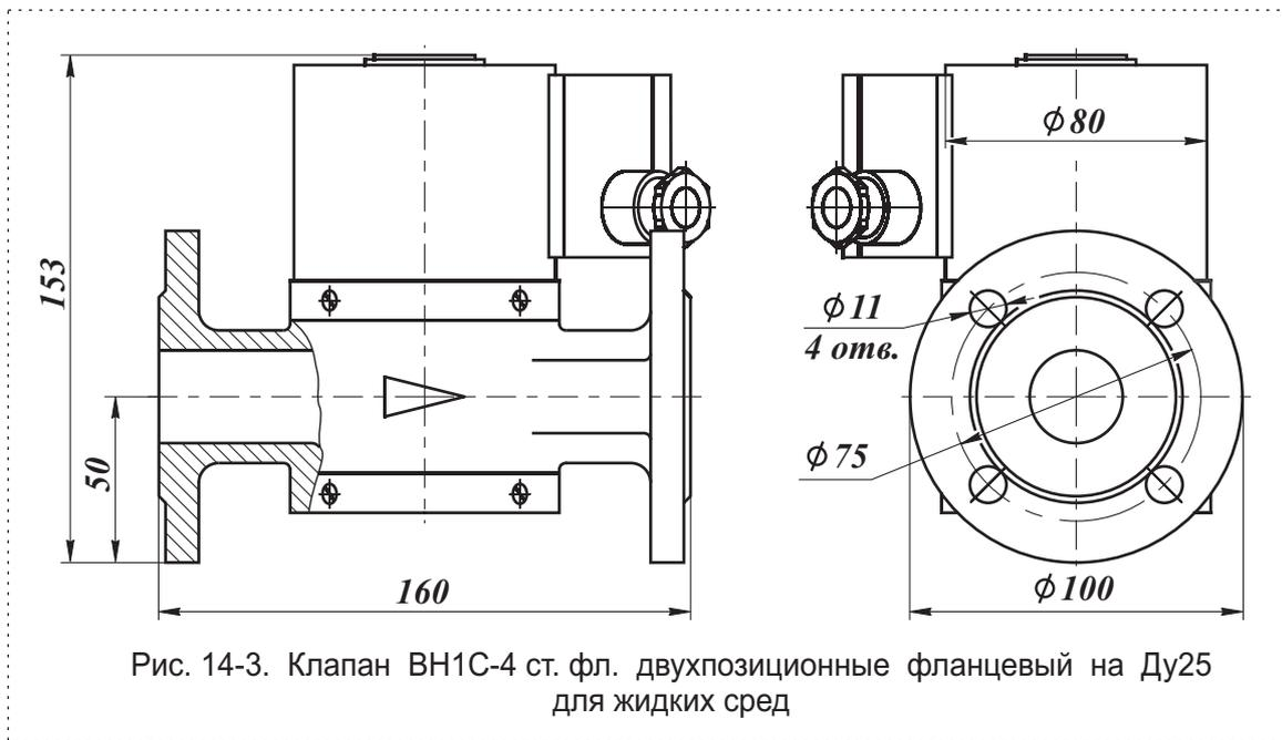
Рис. 14-3. Клапан ВН1С-4 ст. фл. двухпозиционные фланцевый на Ду25 для жидких сред
