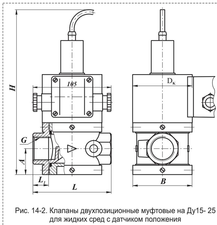
Рис. 14-2. Клапаны двухпозиционные муфтовые на Ду15- 25 для жидких сред с датчиком положения
