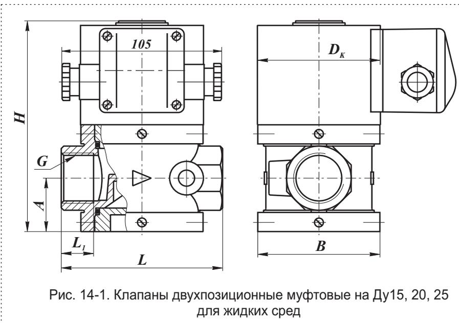
Рис. 14-1. Клапаны двухпозиционные муфтовые на Ду15, 20, 25 для жидких сред
