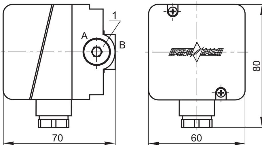
Рис. 23-1. Габаритные размеры датчиков-реле давления типа ДРД
