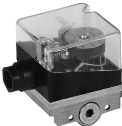
Корпусные детали датчика выполнены из коррозионностойких материалов (сплавы из цветных металлов, высокопрочная пластмасса, маслобензостойкая резина). Мембрана датчика изготовлена из прорезиненной ткани. Крышка выполнена из прозрачной пластмассы.
